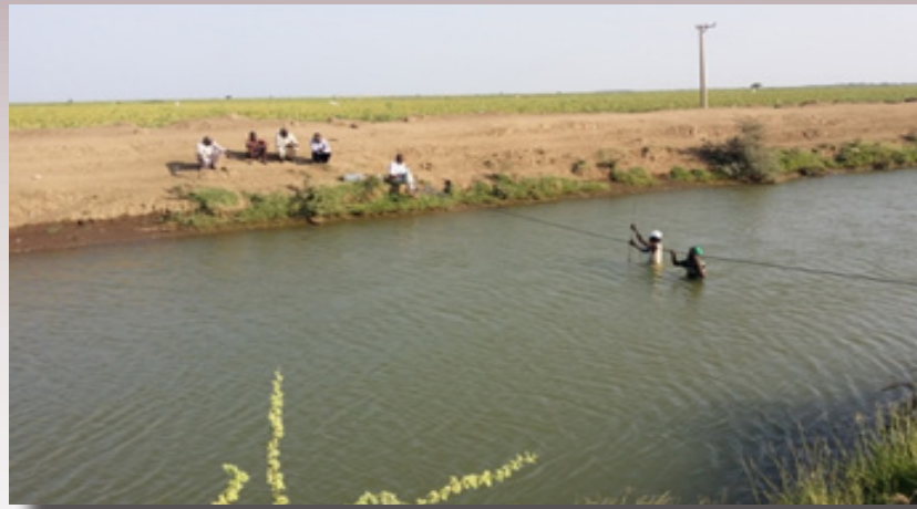
صورة رقم 1: القياس باستخدام نظام الحوض (بيارة كيلو 14 حلفا الجديدة).
