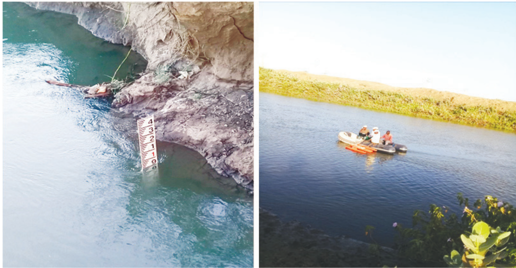
شكل 1: جهاز ال (ADCP) ومسطرة قياس مناسب مؤقتة
